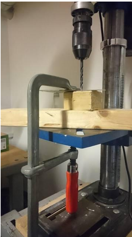
(opstilling til boring i aluminium).
