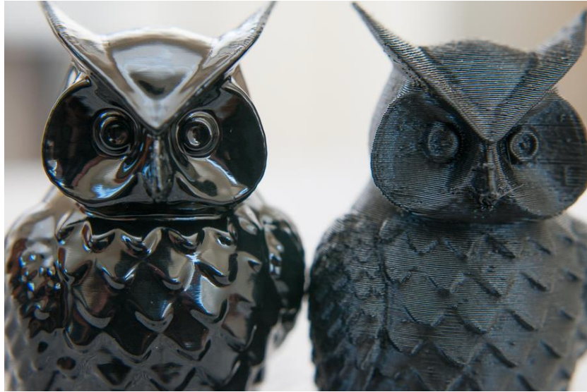
En ugle printet med ABS før (højre) og efter (venstre) acetone behandling.
